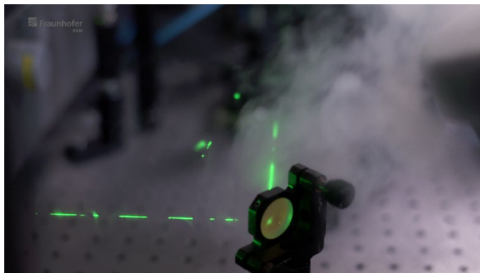
Präzise Fokussierung des Laserstrahls über Spiegel und Linsen auf die Oberfläche der Probe. © Fraunhofer IFAM
