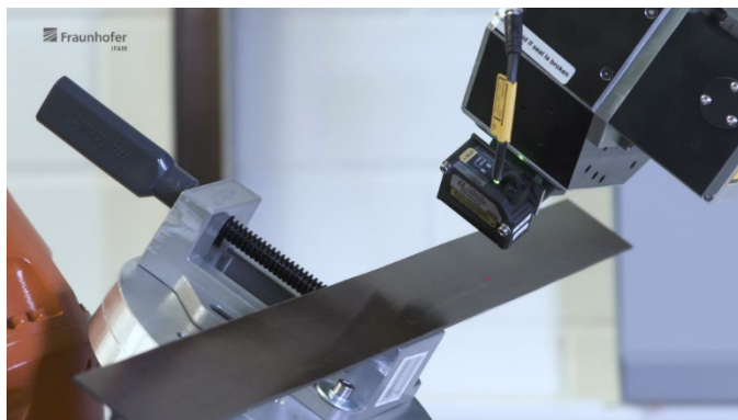
Kompakter LIBS-Messkopf am Robotersystem zur automatisierten Vermessung von Bauteilen. © Fraunhofer IFAM
